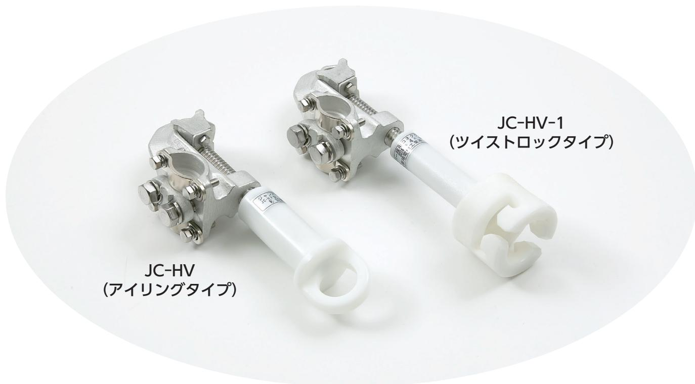
高圧架空配電線路において、機器の取替工事などの際、負荷電流を一時バイパスするジャンパー線を間接活線用工具を用い接続するために使用します。
